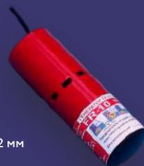
«FR (ФР)» - линейка ГОА марки FUMAROLE (ФУМАРОЛА) с тепловым и/или электрическим запуском, предназначенная для защиты условно герметичных объектов и отличающаяся высокой пожаротушающей эффективностью. Автономные системы запускаются автономно при помощи термощнура, который реагирует на пламя и запускает в действие генератор с огнетушащим аэрозолем.
